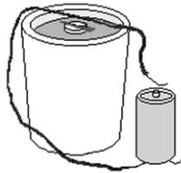
O que acontecerá se fizeres passar o fio sobre o copo, como na figura (ou sobre a tua bússola), colocando as extremidades do fio nos pólos de uma pilha, fechando o circuito eléctrico? Experimenta. O que observas?
