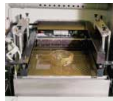
Um raio laser modela o crâneo artificial, camada por camada, num banho de material sintético.
